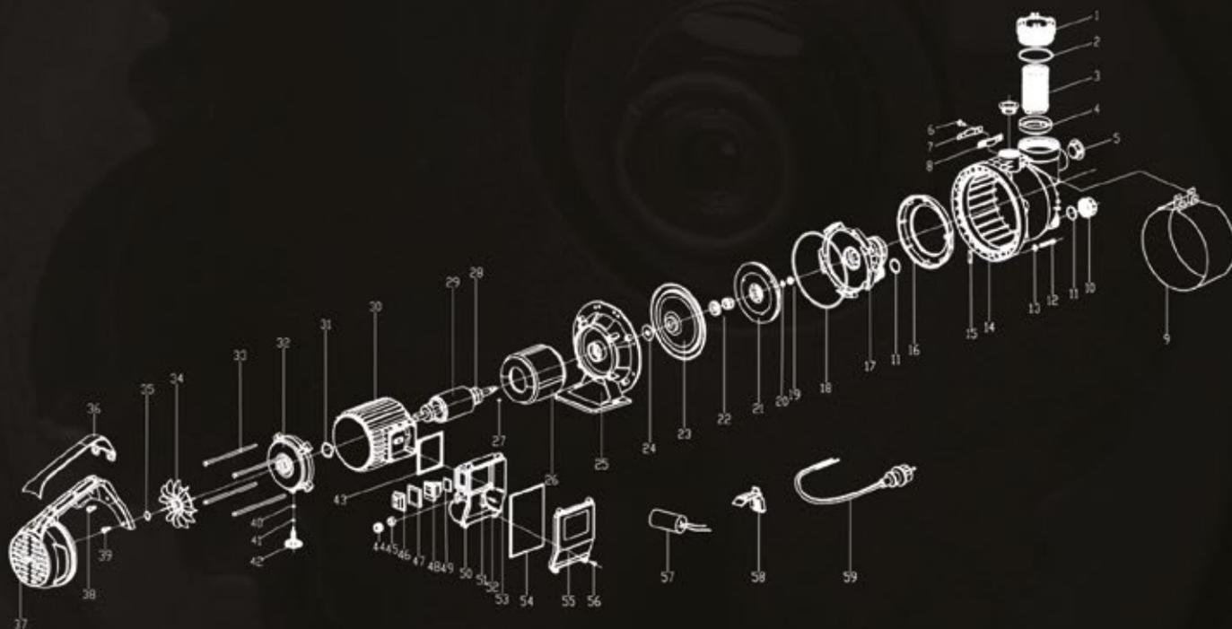
MULT 11300 INOX PUMP DIAGRAM © COPYRIGHT DAMBAT
