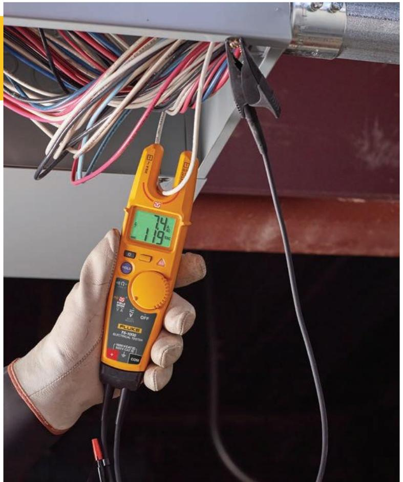
Koska mittaus suoritetaan eristetystä johtimesta, koskettaminen metallisiin johtimiin vähenee. Myös virheiden tai väärän johtimen koskettamisen mahdollisuus vähenee.
