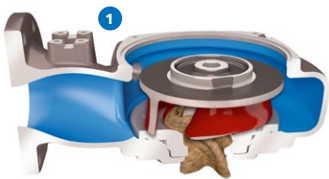
KUVA 1: N-pumpun puoliavoin juoksupyörä ja siirtoura toimivat yhdessä. N-juoksupyörän siivet, joissa on taaksepäin kaartuvat johtoreunat, pyyhkivät kiintoaineet keskeltä tuloaukon kehälle.
