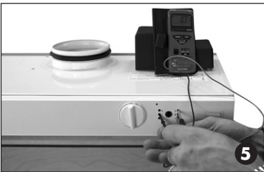
Mittaa jännite navoista – ja S, säädä nopeus 2 potentiometrillä, jne.
