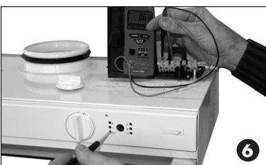
Voit tehdä mittauksen myös liitinrimalta, sähkökaavion osoittamista paikoista.
