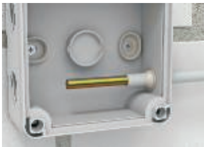
Kaapeliahion tiiviyys Kalvotiiviste tiivistää kaapelin mittatarkasti. Suo- jausluokka säilyy.
