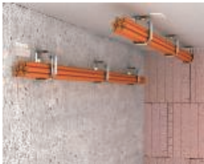
Palonkestävä asennus Metalliset kaapelikiinnikkeet 2033M ja 2034M ovat tyyppihyväksytyjä palonkestävään asennukseen standardin DIN 4102 osan 12 mukaan. Kiinnitysetäisyydet ja hyväksytyt kaapelityypit löytyvät OBO BSS palosuojatuotteiden luettelosta.
