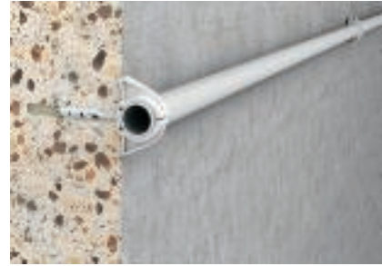
Valmis asennus putki-kiinnikkeellä Kiinnikkeen sivusiivekkeet tarttuvat asennusputkeen ja kiinnittävät sen seinään.
