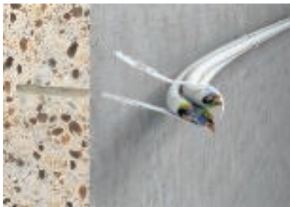
Käyttö: Kaapelikiinnike BKS Porataan reiät, kiedotaan BKS-kaapelikiinnike kaapelien ympärille ja työnnetään kiinnike porareikiin.
