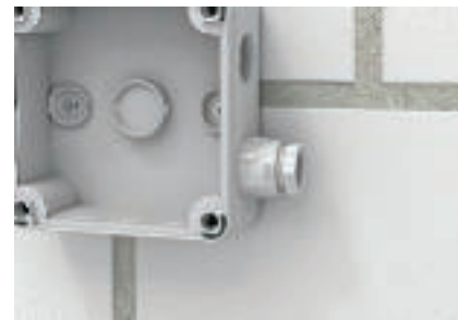
Asennus holkkitiivisteillä ilman vedonpoistoa Holkkitiiviste ilman vedonpoistoa, lyhyellä kier- teellä ruuvataan rasiassa olevaan kierteeseen. Lävistyskalvoa ei tarvitse poistaa.
