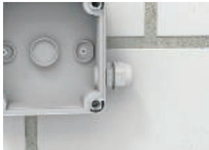
Asennus V-TEC-holkkitiivisteellä Holkkitiiviste, V-TEC, lyhyellä kierteellä ruuva- taan rasiassa olevaan kierteeseen. Lävistyskalvoa ei tarvitse poistaa.
