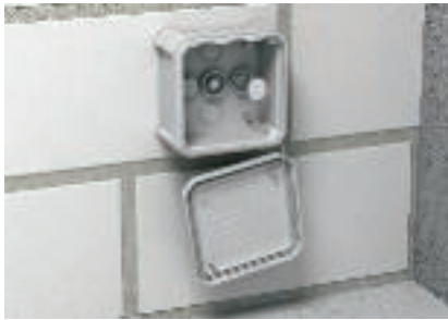
Seinä-/kattokiinnitys Jakorasiat voi kiinnittää kattoon kahden tai neljän murrettavan reiän läpi. Reiät voi sulkea peitetulpilla.
