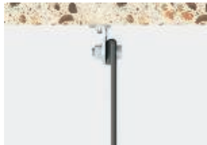
Kuormitustapaus 3: suora ruuvi kiinnitys katto-kiinnikkeeseen, kiinnitysvanteen pää kaksinkertainen, vapaa vanteen pää sisäpuolella. vähimmäismurtokuorma sarakkeen A mukaan
