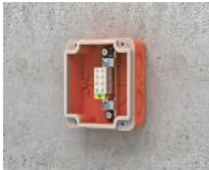
Jakorasian kiinnitys Rasia kiinnitetään kytkentälaattoineen betoni-ruuveilla palamattomaan alustaan. Avain T30, kiristysmomentti maks. 3 - 8 Nm.
