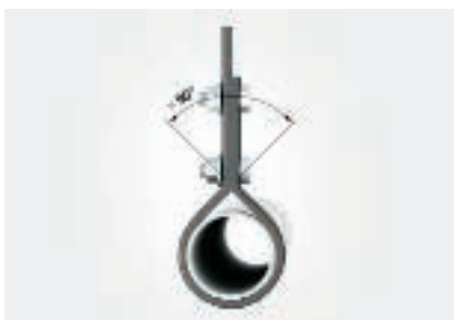
Kuormitustapaus 8: sennusputken tms. yksinkertainen vanneripustus. vähimmäismurtokuorma sarakkeen A mukaan
