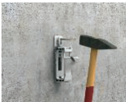
Kiinnitys lyöntitulpilla Lyöntitulppa työnnetään kiinnitysosaa porareikään ja lyödään vasaralla kiinni.
