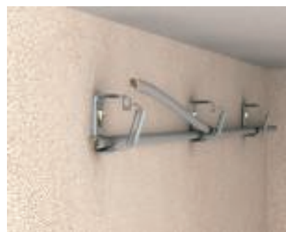
Kaapelien asennus Kaapeleiden asennus kaapelikiinnikkeisiin. Kun kaapelit on asennettu, kiinnikkeet suljetaan työntämällä kiinnikkeen pidin aukkoonsa.
