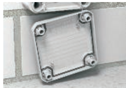
Kannen tiiviste / IP-suojaluokka Jakorasiat on varustettu koosta T 60 lähtien vaahdotetulla kannen tiivisteellä. Näin saavutetaan korkea suojaluokka IP66.
