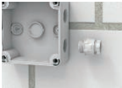
Asennus holkkitiivisteillä ilman vedonpoistoa Vaihtoehtoisesti voidaan holkkitiivisteet ilman vedonpoistoa ruuvata kiinni myös lyhyellä liitos- kierteellä jakorasioissa B 9/T.
