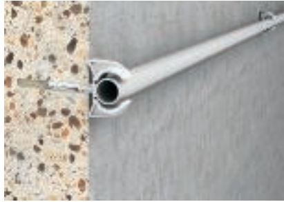
Snap-kiinnikkeen asennus Sijoita kiinnike reikään. Aseta putki kiinnikkeeseen ja paina kiinnikettä putkella pintaan.
