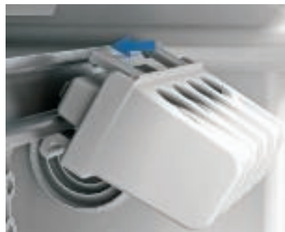
KytKentäliittimien lukitus Liitinkisko napsautetaan jakorasian sisäpuolelle ja lukitaan painamalla kevyesti jakorasian ulkolaitaa vasten.
