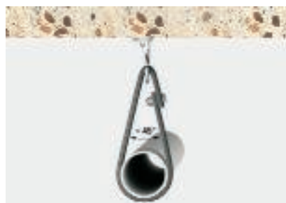
Kuormitustapaus 6: koukkuripustus, vanne kie- dottu koukun ja putken tms. ympärille. vähimmäismurtokuorma sarakkeen 2xB mu- kaan
