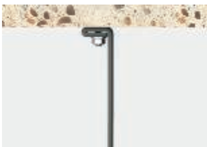
Kuormitustapaus 5: ruuvikiinnitys aluslevyllä kattoon, kiinnitysvanteen pää kaksinkertainen, vapaa vanteen pää sisäpuolella. vähimmäismurtokuorma sarakkeen B mukaan
