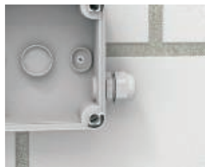
Asennus V-TEC-holkkitiivisteellä Holkkitiiviste, V TEC, lyhyellä kierteellä ruuvataan rasian kierteeseen. Kalvotiivistettä ei tarvitse poistaa.
