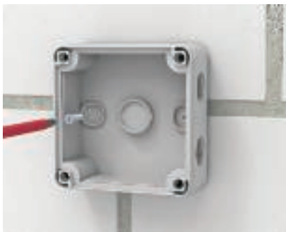
Kiinnitys - B 9/T Pohjassa olevissa kiinnitysrei'issä on lävistyskalvo, johon ruuvi kiinnittyy ja joka takaa tiiveyden.
