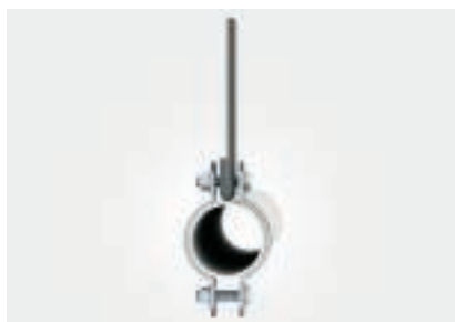
Kuormitustapaus 10: Asennusputken tms. yk- sinkertainen vanneripustus putkikiinnikkeeseen, vanteen pää kaksinkertainen. vähimmäismurtokuorma sarakkeen A mukaan
