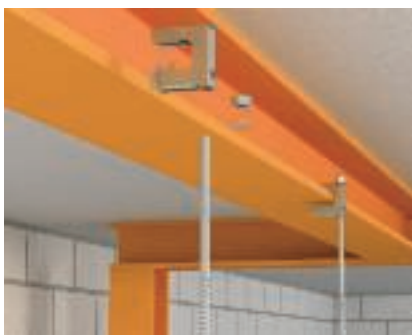
Käyttö: Kierretanko Kierretangot M6 - M8 voidaan asentaa takapuolen aukkoihin (8 x 9,5 mm).
