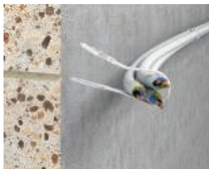
Käyttö: Kaapelikiinnike BKS Porataan reiät, BKS-kiinnike kiedotaan kaapelin ympärille ja työnnetään porareikään.
