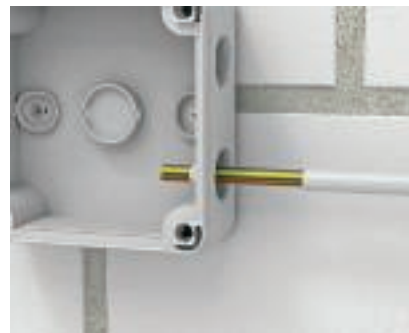
Kaapelin sisäänvienti B 9/T jakorasian kalvotiiviste lävistetään kaapelilla ilman työkaluja.
