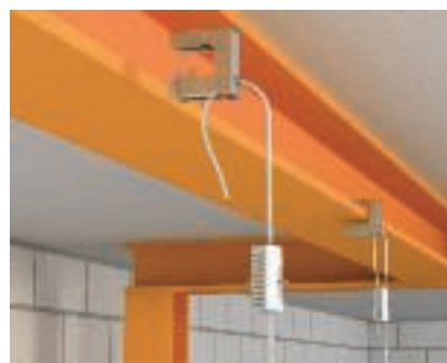
Käyttö: Vaijeri Palkikiinnikkeen pystysuora aukko (taustapuolella 8 x 9,5 mm) mahdollistaa sen käytön vaijerin kanssa.
