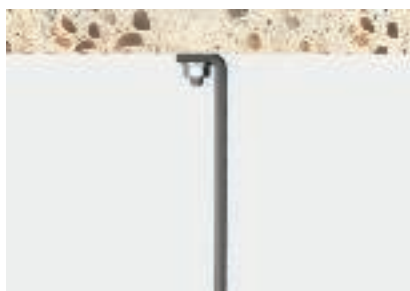
Kuormitustapaus 4: ruuvikiinnitys aluslevyllä kattoon. vähimmäismurtokuorma sarakkeen C mukaan
