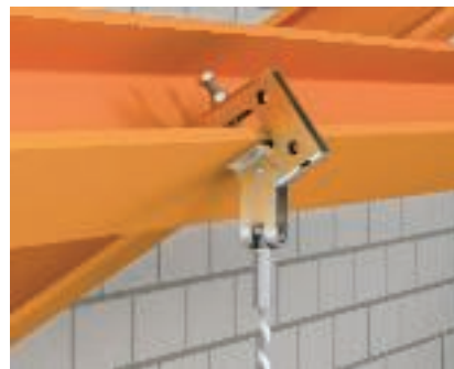
Käyttö: Palkikiinnike nivelellä Kun tehdään ripustuksia kalteviin teräsrakenteisiin, voidaan käyttää palkikiinnikkeitä nivelellä. Kiinnike kiinnitetään palkkiin ruuvilla.
