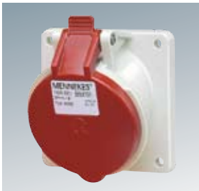
⚠ IP 44 CEE-pistorasia, paneeliasennus, ruuviton TwinCONTACT, standardi laippa: mitat 85 x 85 mm, 20° kallistus Mitat: sivu 70/71
