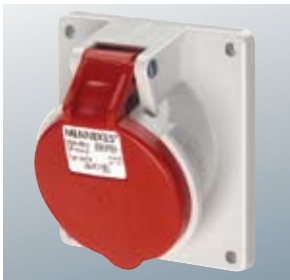
⚠ IP 44 CEE-pistorasia, paneeliasennus, ruuviton TwinCONTACT, laippa: 16 A, 3-nap.: 73,5 x 64 mm, 16 A, 4+5-nap., 32 A: 100 x 92 mm, 20° kallistus Mitat: sivu 70/71
