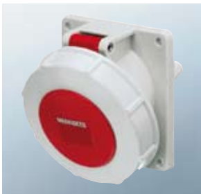
⚠ IP 67 CEE-pistorasia, paneeliasennus, ruuviton TwinCONTACT, laippa: 16 A, 3-nap.: 73,5 x 64 mm, 16 A, 4+5-nap., 32 A: 100 x 92 mm, 20° kallistus Mitat: sivu 71
