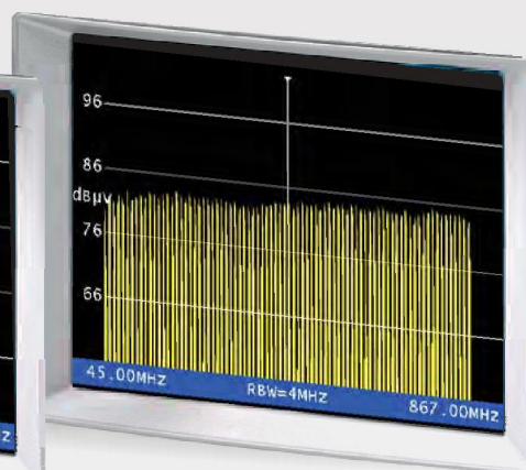
Comb-signaalianalysaattorinäyttö - taajuusalue 44 - 867 MHz on näytöllä 10 MHz asteikolla.
