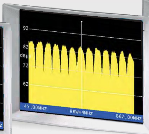
Pystysuuntainen aalto - NCG 230:lla luotu refleksionäyttö avoimella koaksiaalikaapelilla.
