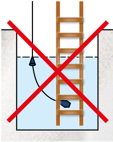
Kuva 4. Huomioi kellukkeen vapaa liikkuminen.
