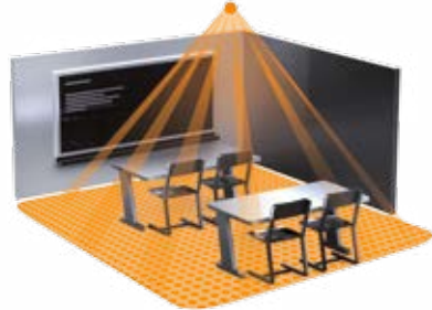
Tilanne luokkahuoneessa, tunnistus Presence Control Pro IR Quattro -järjestelmällä, neliömuotoiset tunnistusalueet
