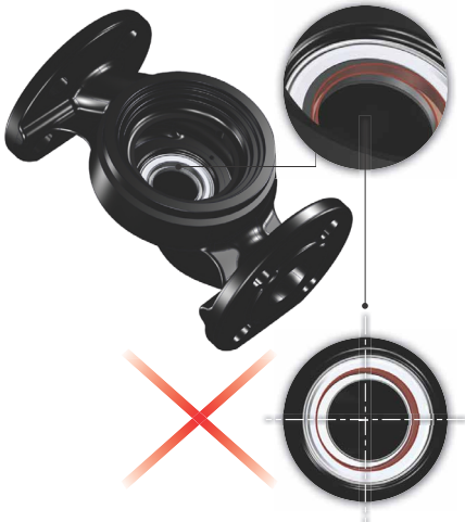
Kuva 15 Virheellisesti keskitetty tiivistejärjestelmä
