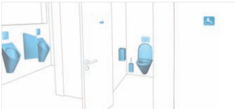
WC- JA URINAALITILA: urinaalit, urinaalien väliseinä, huuhteluventtiilit, vaatekoukku, WC-paperiteline, WC-harja ja harjatelina, WC-istuim, WC-huuhtelupainike, symboli
