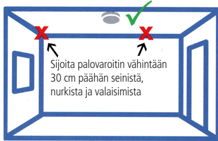
Varoittimen asennus huoneeseen
