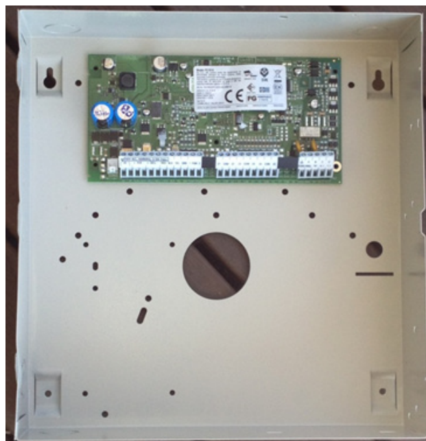
Kuva 1. Elektroniikkakortin kohdistus keskuskoteloon.
