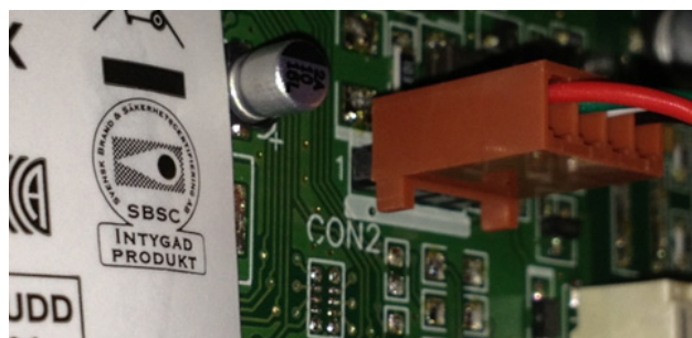
Kuva 7. PC-link kaapelin kiinnitys keskuksen elektronikkakorttiin.
