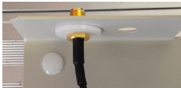
Kuva 6. Antennikaapelin runkoliittimen kiinnitys asennuskehikkoon.
