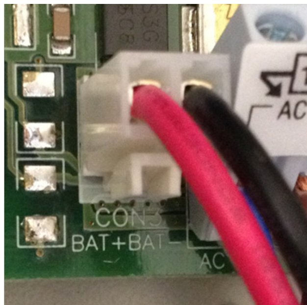
Kuva 10. Akkuliittimen kiinnitys keskuksen elektroniikkakorttiin.
