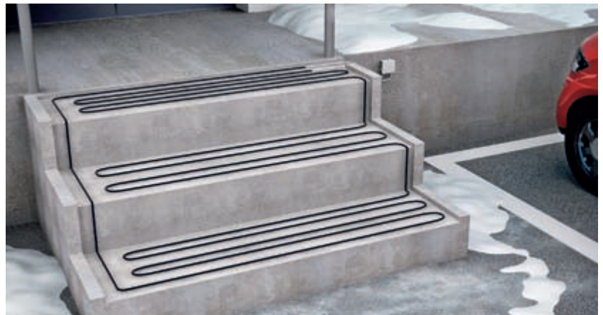
Tash-vakiovastus-kaapelin asennus tehdään aina lenkiksi ja johdin vietään takaisin rasiaan. (KUVA OHJEELLINEN)
