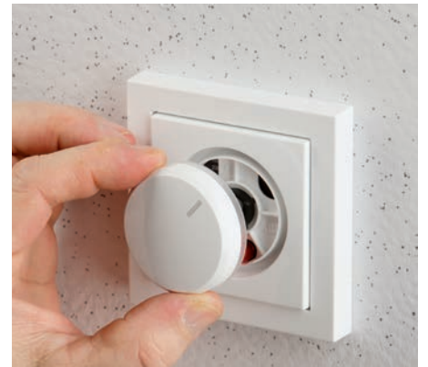
Uudistettu IMPRESSIVO®-kiertonuppisäätimen keskiö sallii säätimen asentamisen myös kosteaan tilaan. Se on sellaisenaan asennettuna sileälle pinnalle IP21, ja karhealle pinnalle IP21 tiivisteiden kanssa.
