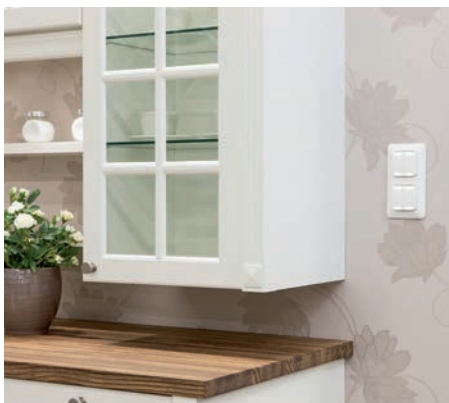
Uudistuneissa valaistuksenohjauspainikkeissa on 4 painiketta sulkeutuvilla koskettimilla, joiden kuormitettavuus on 1 A. Kullakin painikkeella on oma erikseen kytkettävä valkoinen LED-merkkivalo, jonka kirkkautta voi säätää portaittain. Painiketaulua voi käyttää myös 2-painikkeisena kytkemällä yhden vivun molemmat painikkeet rintaan. Asennetaan sellaisenaan pintaan tai peittämään upporasiaa.
